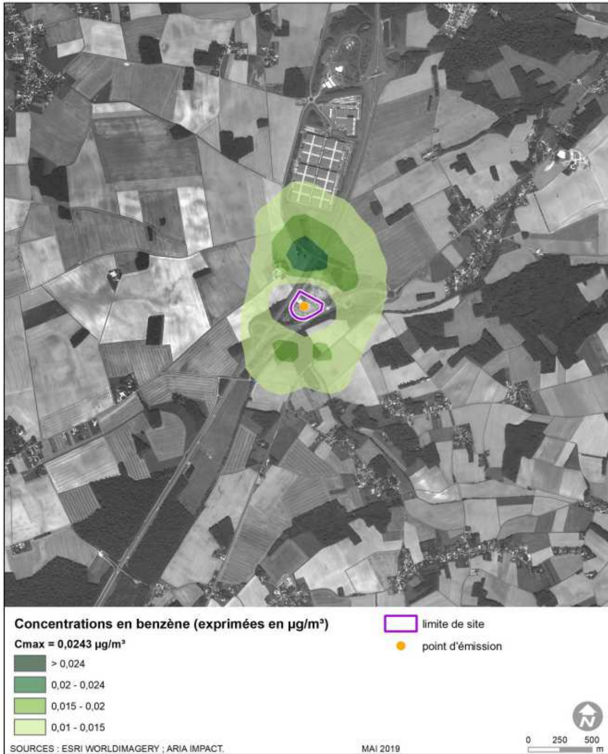
Figure 39 : Modélisation de la dispersion atmosphérique du benzène
